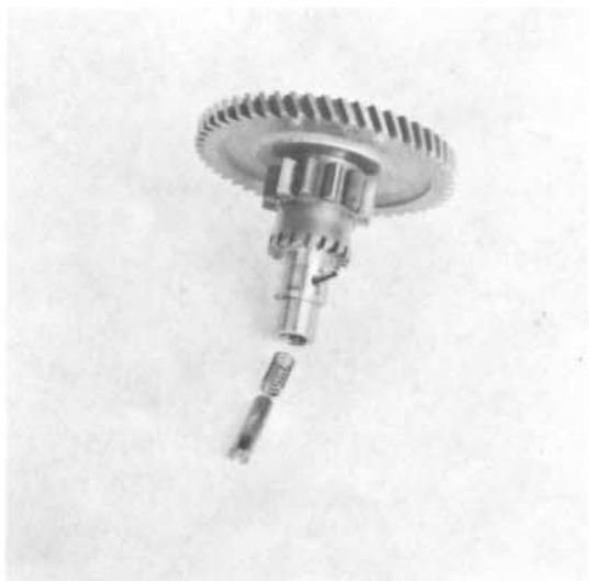
8) Feder mit Antriebswelle für die Hydraulikpumpe.
