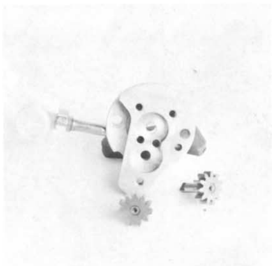
18) 3 Schrauben lösen (SW 10), Platte abnehmen, beide Zahnräder abnehmen.
