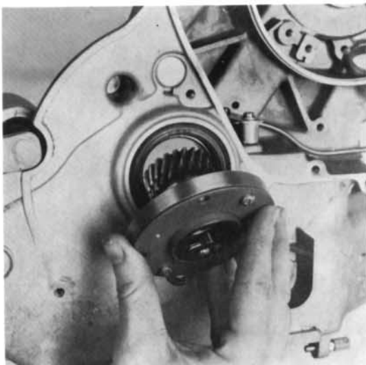
41) Freilauf und Zahnrad herausziehen.
