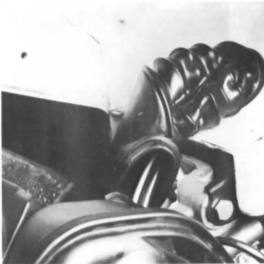
8) Gummiabsaugstutzen vom Gehäuse abziehen (Schelle lösen).
